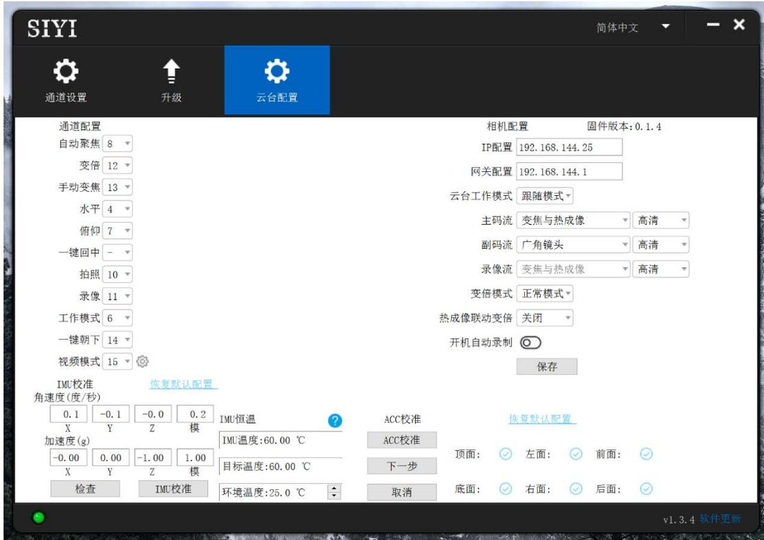
7. 在通道配置选项下，分配所需的遥控通道（1~16）给对应的云台和相机功能。
