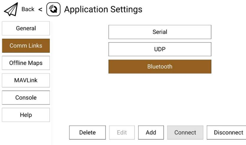
6. 选择设置好的“Bluetooth”连接方式并点击“Connect”, QGC 地面站顶部进度条有变化即说明遥控器与地面站的数传通信已经进入自动连接的过程, 连接完成后即可正常通信。
